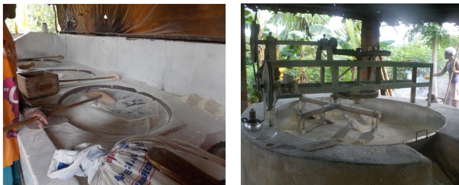
Figura 2 - Etapa da torrefação da farinha de mandioca em forno de barro e em forno mecanizado, em Nazaré-BA, 2012/2013
