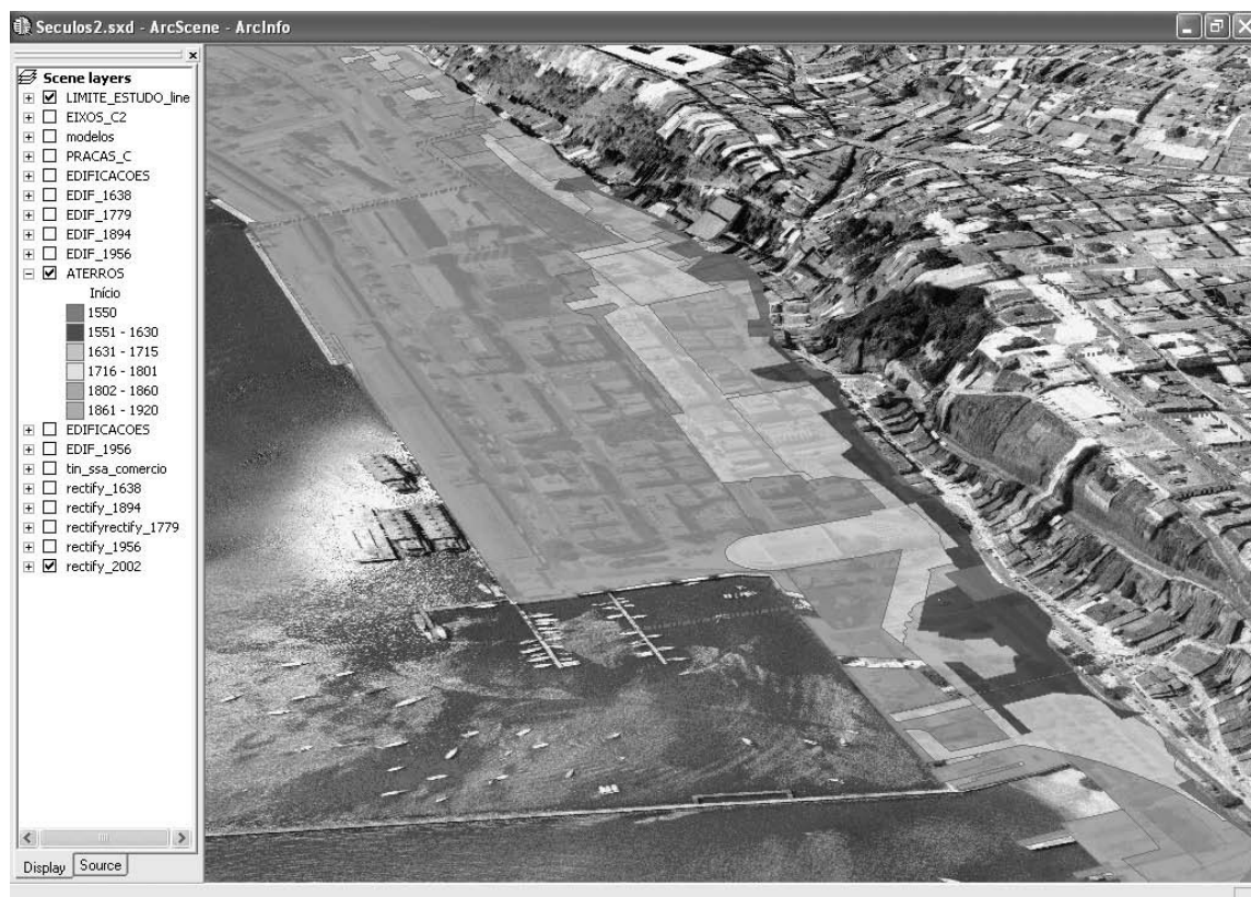
Figura 2 – Visualização de tela do ArcScene com os sucessivos trechos de aterro, aplicados à foto aérea de 2002 e ao MDT.
